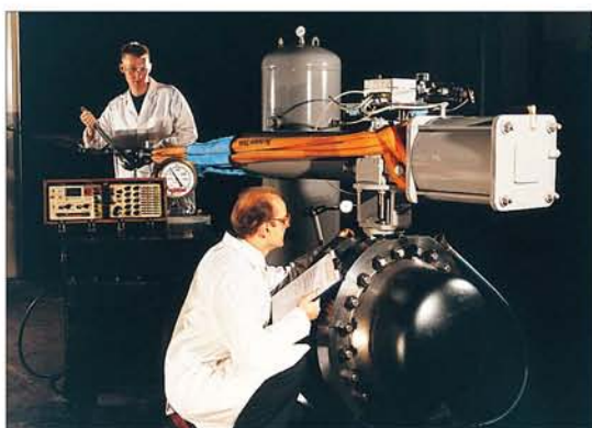
用于核电的控制蝶阀正在接受抗震试验。
