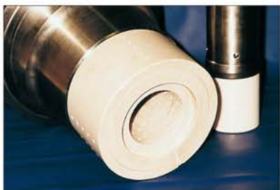
三级降压的陶瓷内件阀，应用于给水泵再循环系统，压差为290bar (4205psi)。
