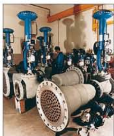
为中东的海水淡化系统提供的出口带消音器的阀门。
