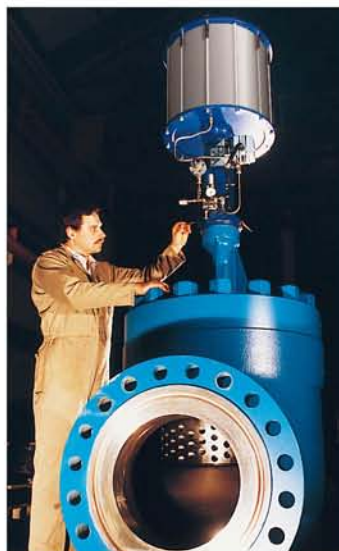
压缩机防喘振阀，应用于阿布扎比的天然气工厂，是该大型工程重要的一部分。
