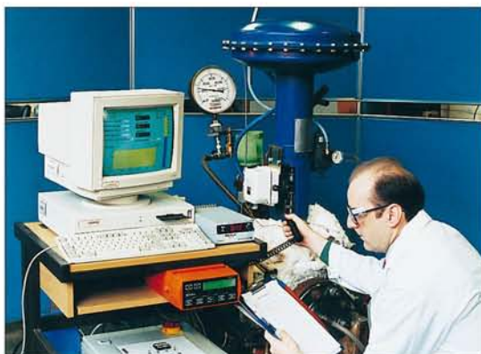
装有密封填料的阀门正在进行填料密封试验，试验介质为氦气，试验压力为40bar(580psi)，试验温度为200°C(392°F)。
