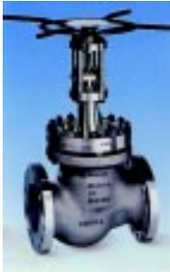
特殊合金截止阀 • 用于苛刻状况 • 照片: 10", ANSI 300# 用于无水HF, 450°C • 材料: Inconel 600
