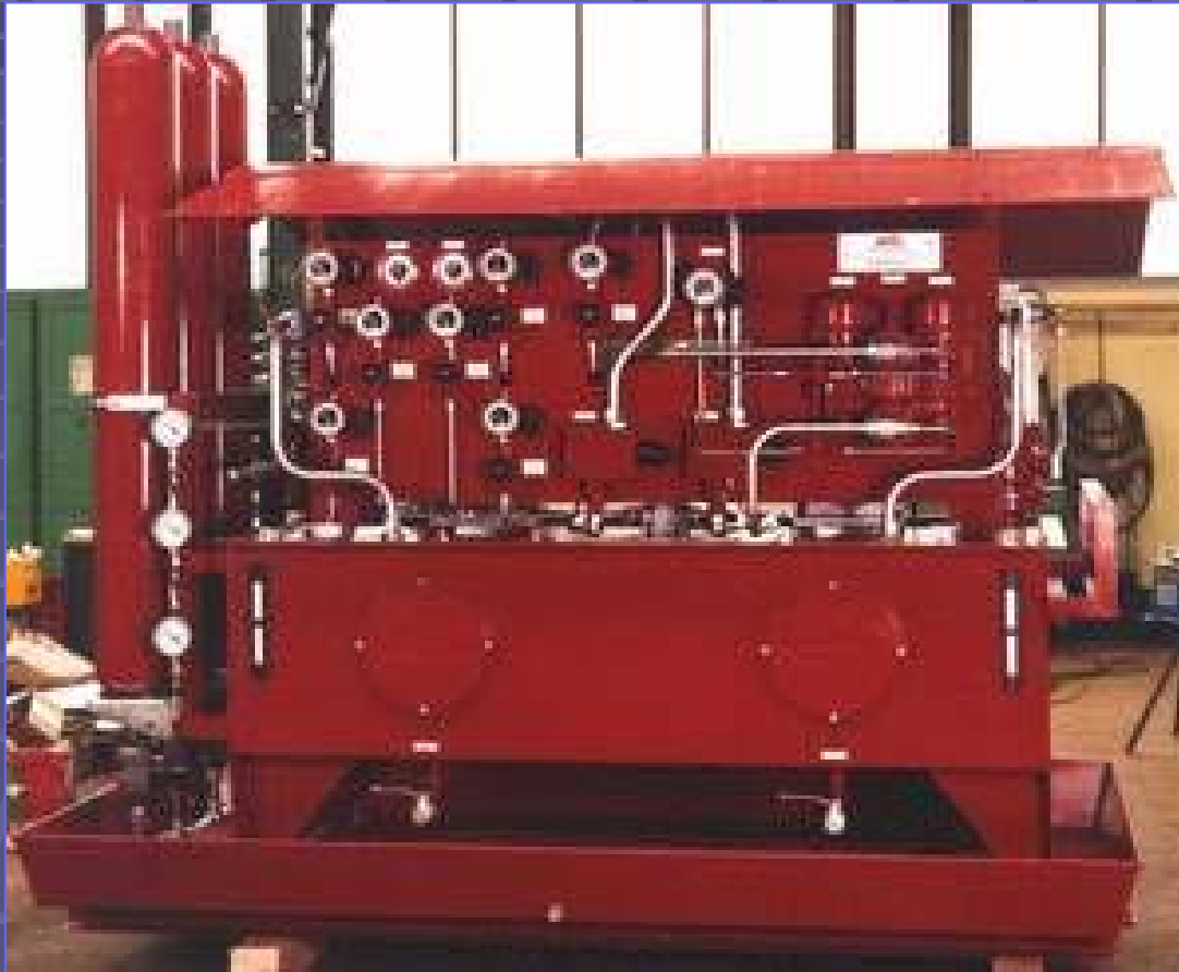
帶有液動執行機構的兩個旁路閥和減壓閥
