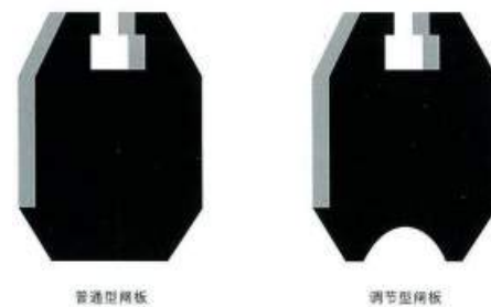
图7、无导流孔闸板结构图
