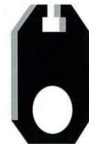
图5、带导流孔闸板结构图
