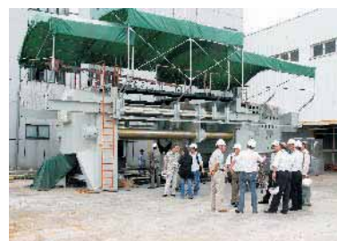
4600吨大型阀门性能试验台 (中国第一台) 4600-ton large scale performance test bench
