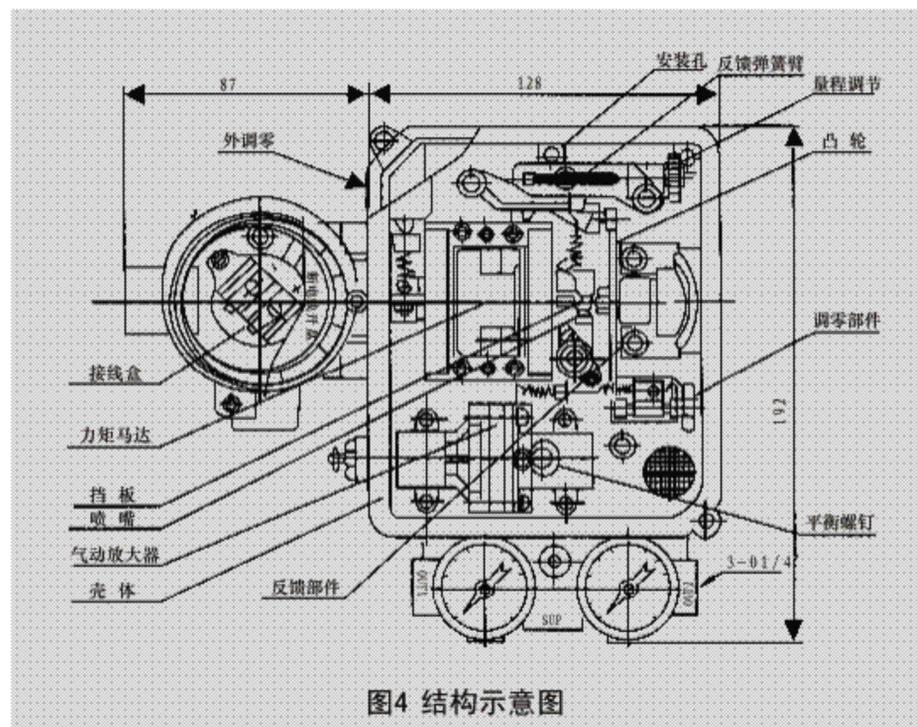
本安型定位器符合GB3836.1—2000《爆炸性环境用防爆电气设备通用要求》及GB3836.4—2000《爆炸性环境用防爆电气设备本质安全电路和电气设备“i”》有关规定要求。在设计结构电气线路上采取防爆措施，使电路在正常工作和故障状态下产生的电火花和热效应，均不能点燃规定的爆炸性混和物。
