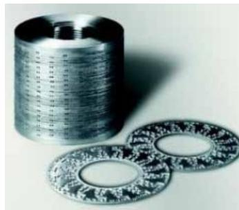
2, 每个迷宫盘中流道根据降压级数的不同具有不同的数量的转角和压缩或扩张的流道沟槽, 采用最少七片, 最多十五片的迷宫盘叠加结构。
